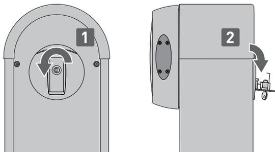
En caso de avería o falta de tensión, introduzca la llave y gírela en sentido antihorario y abra completamente la puertecilla. Abra la barrera manualmente.
