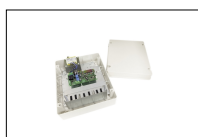
B71/PBX36/BOX/115 Inverter híbrido versión "Network Assisted" para la alimentación de la automatización, con función de carga de baterías, a través de la conexión a los paneles solares o red fija, para alimentar los controladores digitales Brushless de 36V DC con tensión de red de 115V AC.
